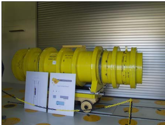
Kjellerflaska brukes til å transportere høyaktivt brukt atombrensel mellom Halden og Kjeller. Her er den fotografert i lageret for brukt reaktorbrensel på Kjeller. Foto: Thomas Nilsen/ Bellona.
